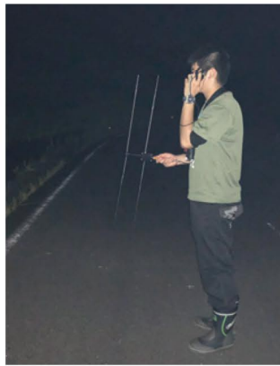
▲アンテナでフクロウからの電波を探す部員 ※テレメトリ調査 野生動物に発信機を取り付け、アンテナで発信機からの電波を受信し、動物の移動を追跡する調査
