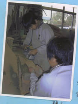
写真1: チェンソーで材木を切っている様子。作業には多くチェンソーを用います。森と密着の作業です。 写真2: 電気鉋で角材を作っている様子。
